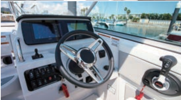
コクピット左舷には長めのベンチシート、コクピット右舷前部がヘルムステーションだ。ステアリングホイールの他、各種ディスプレイ、スイッチ類をバランスよく配置。シフトレバーは艇体側面に取り付けられている。中央はキャビンへのコンパニオンウェイだ。
