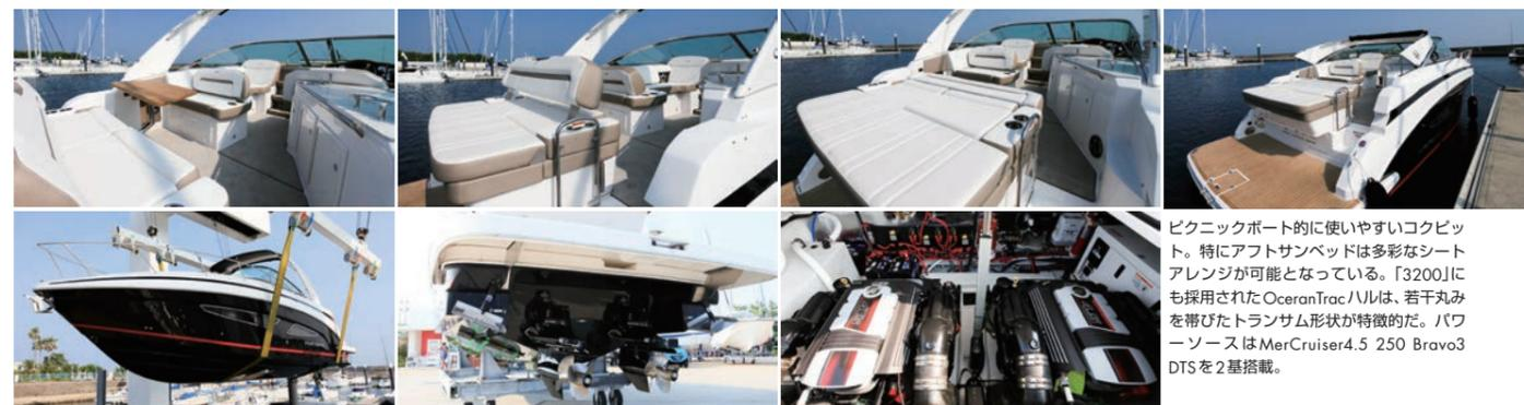
ピクニックボートの使いやすいコクピット。特にアフトサンベッドは多彩なシートアレンジが可能となっている。「3200」にも採用されたOceanTracハルは、若干丸みを帯びたトランサム形状が特徴的だ。パワーステアリングはMerCruiser4.5 250 Bravo3 DTSを2基搭載。
